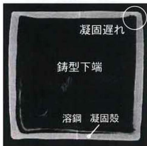
凝固殻を明確に識別するため画像処理を加えています。
