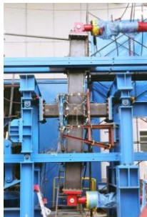
十字形架構実験状況
