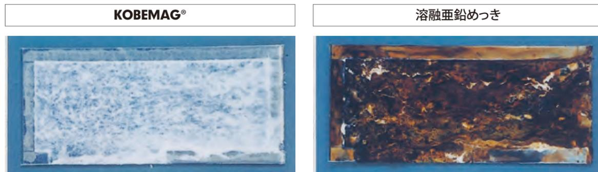
\* 塩水噴霧試験 2 5 0 0 時間後の表面外観を比較 (めっき付着量: 90/90 g/m<sup>2</sup>、無処理)
