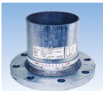
パイプとフランジの溶接例 (2層溶接、200A-20V、 フランジ亜鉛目付量>750g/m 2 、CO 2 )
