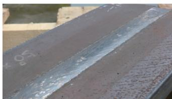
突合せ溶接一例 25mmt 50° V GAP= 5 mm
