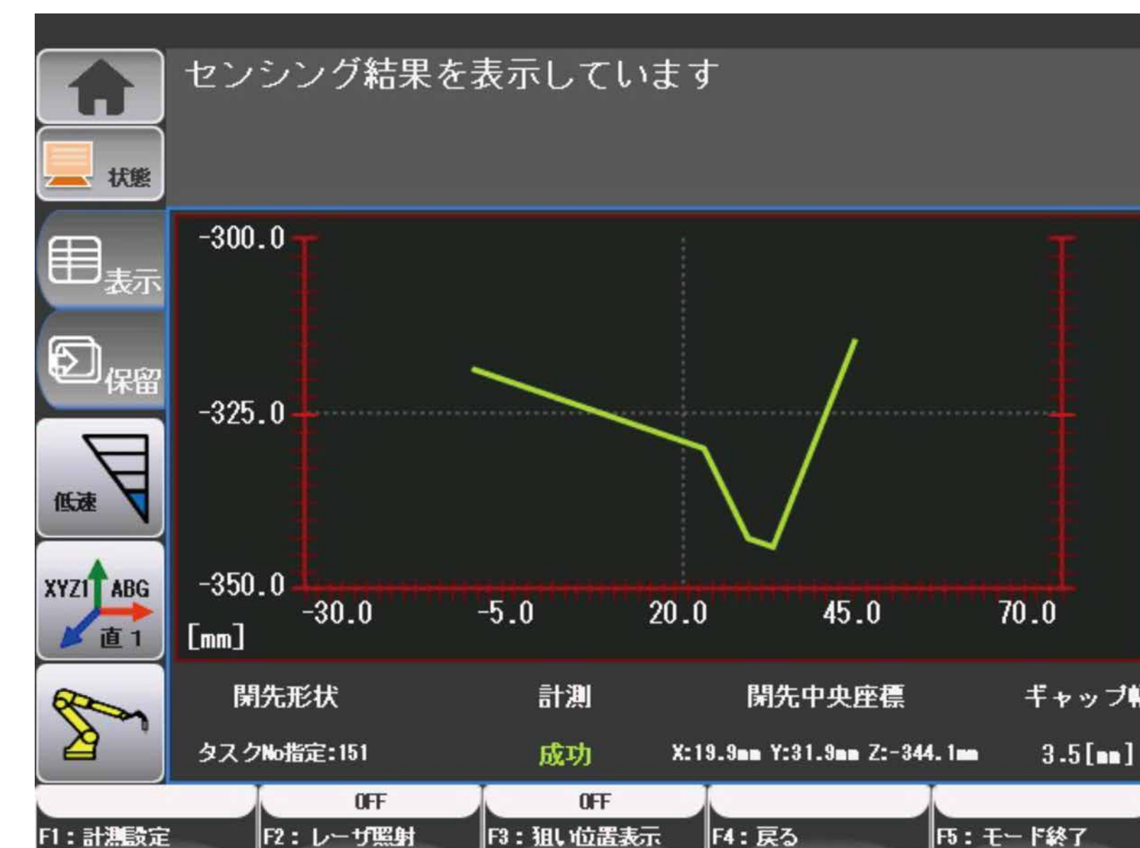
計測結果をティーチングペンダントに表示
