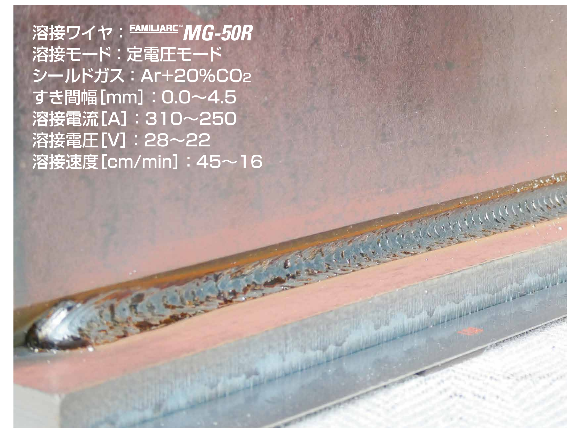
ビード外観写真 GAP=0mm(アークスタート側)～GAP=5mm(クレータ側)
