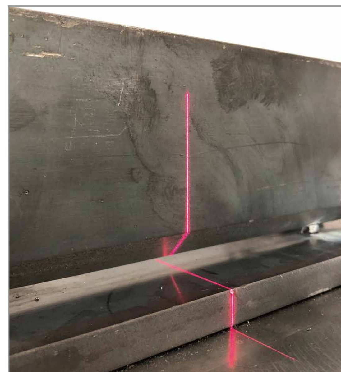
ラインレーザで検出動作削減
