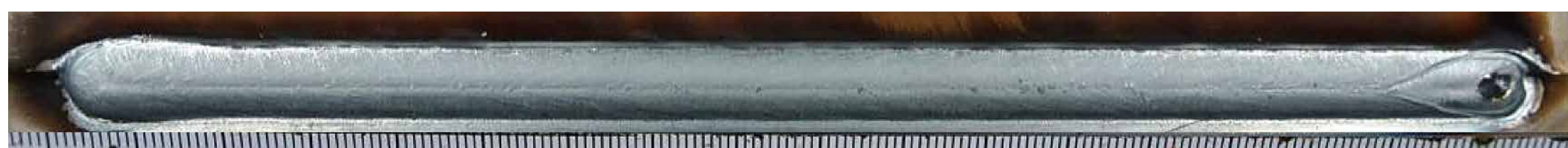
Ar+5%CO 2 440MPa級鋼板 板厚2.0mm 重ねすみ肉溶接
