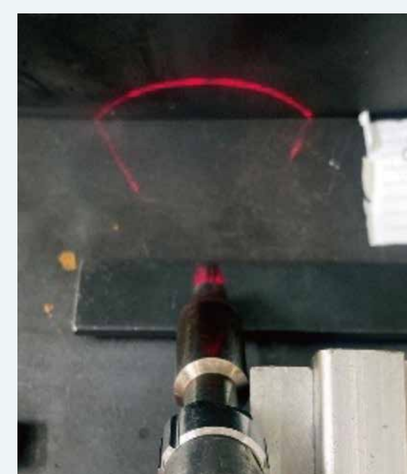
※波長650nmの低出力可視光レーザを用いたワイヤ反射試験結果の一例
