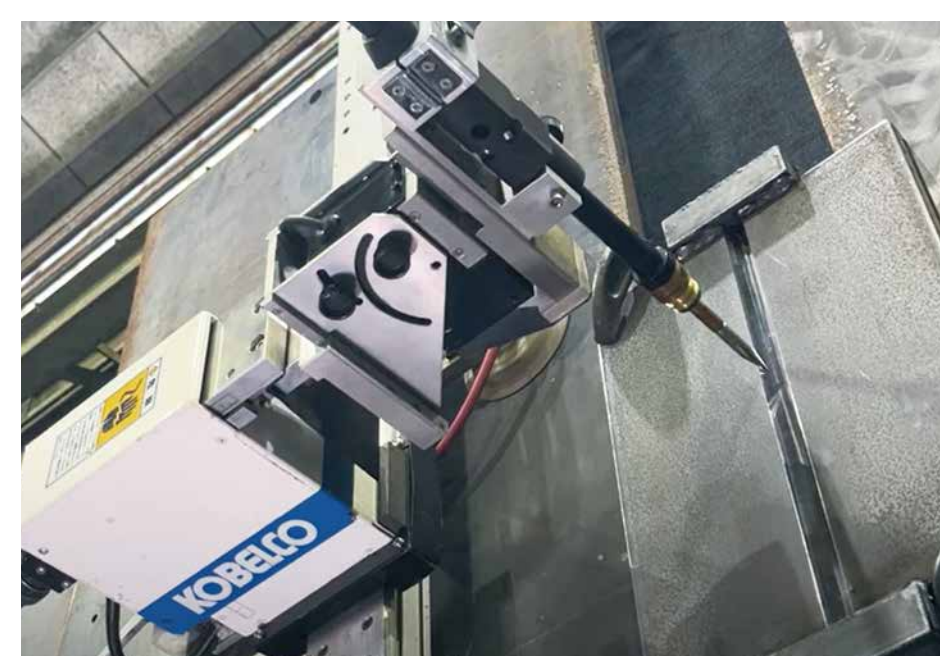
タッチセンシングによる 開先形状の自動検出
