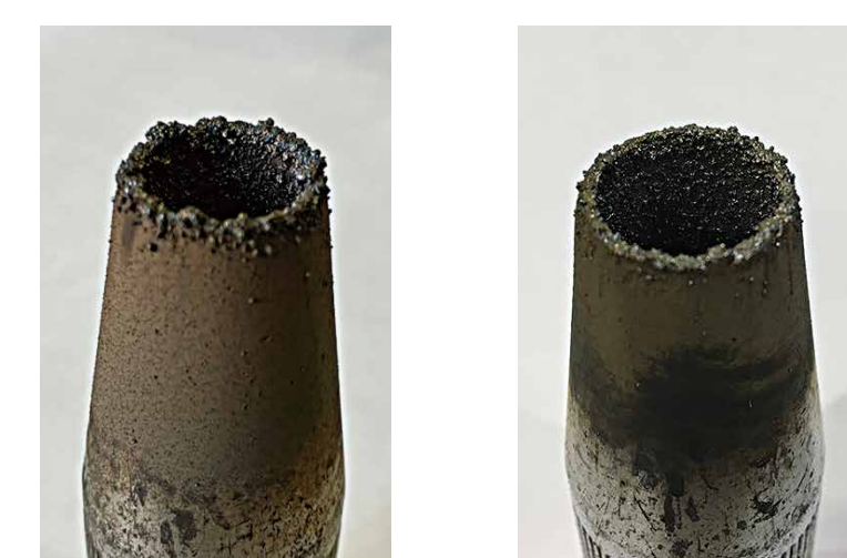
従来溶接機 Conventional welding machine （板厚32mm 7層12パス溶接後／ノズル清掃無し）
