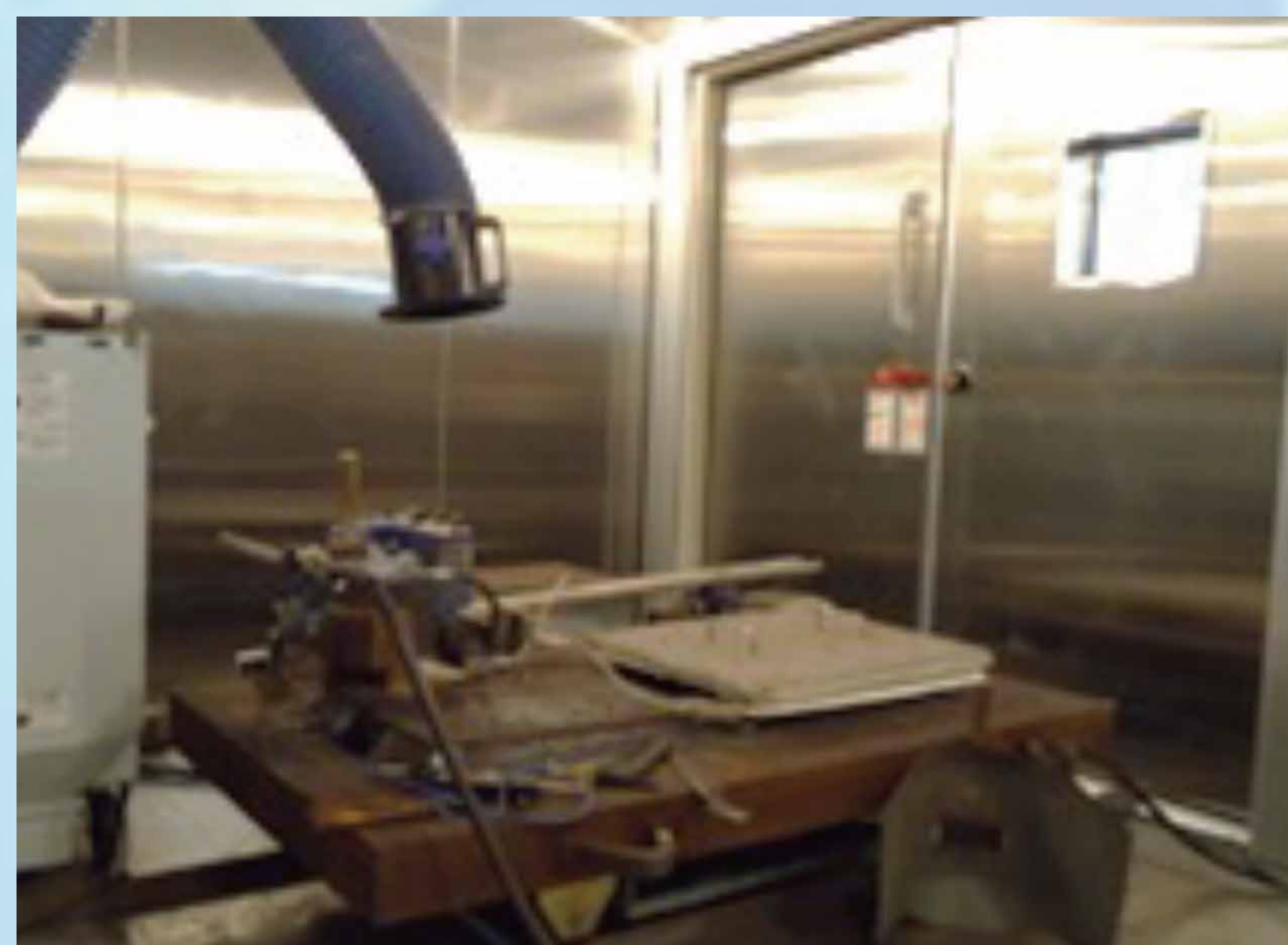
実溶接施工模擬試験 (温度・湿度管理)
