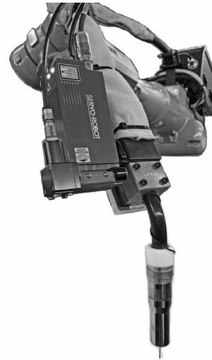
図4 レーザセンサ付き溶接トーチ
