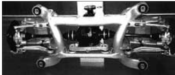
写真5 BMW 528iのオールアルミサスペンション Photo.5 All-aluminum suspension in BMW 528i
