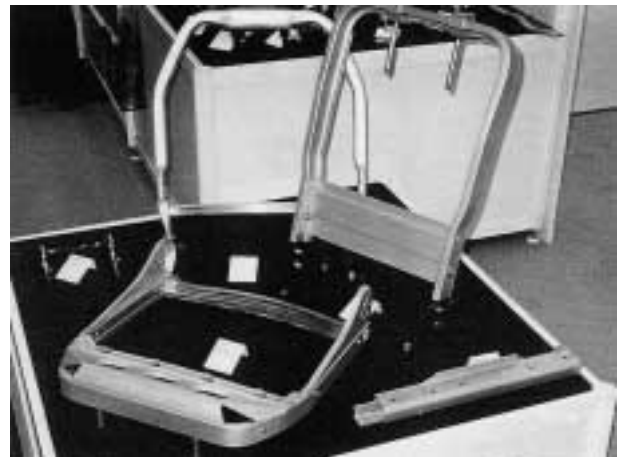
写真4 アルミパイプをハイドロフォーミングしたシートフレーム Photo.4 Seat frame made of aluminum pipe by hydro-forming process
