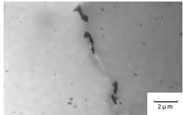
写真1 Al-1.3%Si-0.6%Mg合金のT4における析出粒子(溶体化温度;530)
