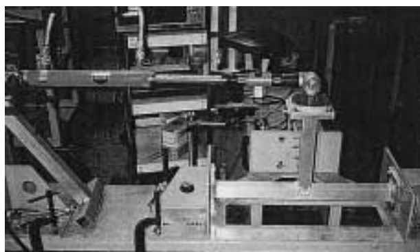
写真1 結合体の曲げ試験状況
