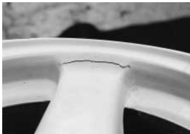
写真1 鍛造ホイールにおけるリムフランジ破壊 Photo.1 Crack observed at the rim flange
