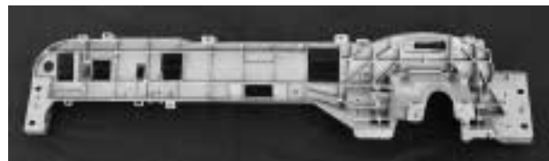
写真 1 Chevrolet Astro 用インストルメントパネル (板厚 3.5mm, 全長 1 550mm)
