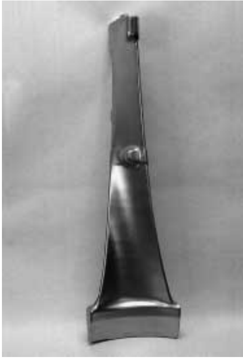
写真1 3ステップ法で鍛造したTi-6Al-4V製40インチブレード
