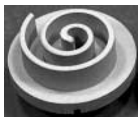
第8図 アルミ合金製鍛造スクロールと羽根成形に及ぼす摩擦状態の影響 m_f : 摩擦係数
