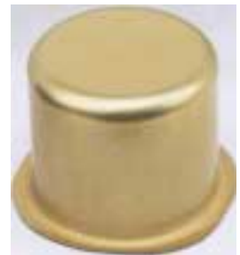
写真2 プレス加工例(潤滑油使用)
