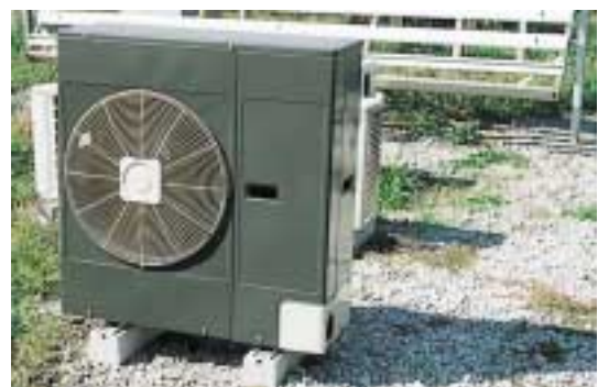
写真1 エアコン室外機の暴露試験状況
