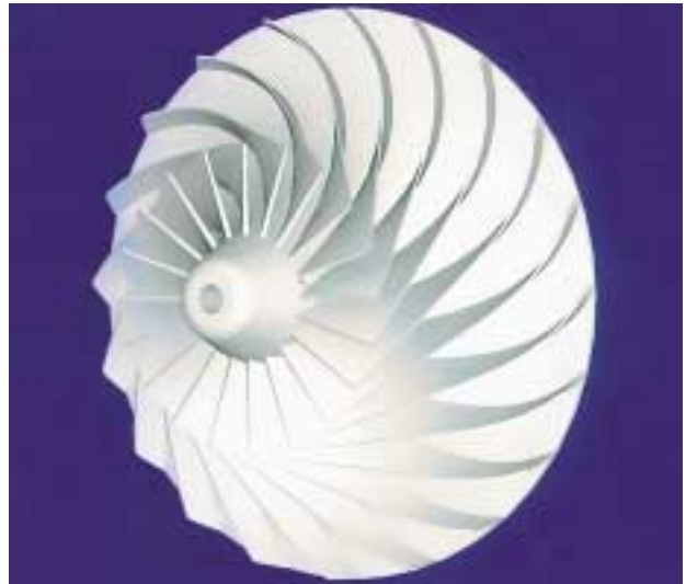
第2図 インペラソリッドモデル Fig. 2 Impeller solid model
