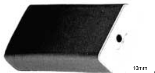
写真 1 アルミニウム製リチウムイオン電池ケースの外観（重量約 4g）
