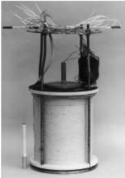
写真1 Bi-2212 ソレノイドコイルの外観 Photo 1 Appearance of Bi-2212 solenoidal coil
