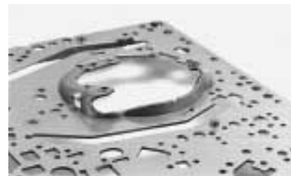
第1図 打ち抜き加工性と深絞り性(r値) 写真1 VTR用シャーシへの適用例
