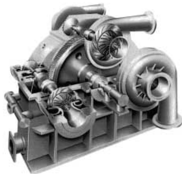
第1図 増速機内蔵型遠心圧縮機の構造 Fig. 1 Construction of integrally geared centrifugal compressor
