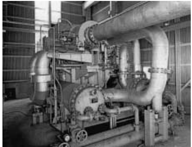
写真5 酸素圧縮機の例 Photo 5 Example of oxygen Super Turbo
