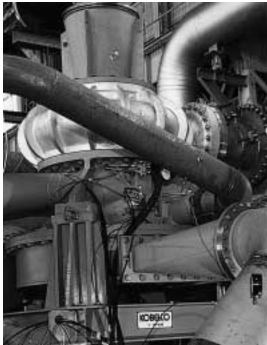
写真1 5000kW級燃料電池用タービン圧縮機 Photo 1 Turbo compressor for 5000kW fuel cell
