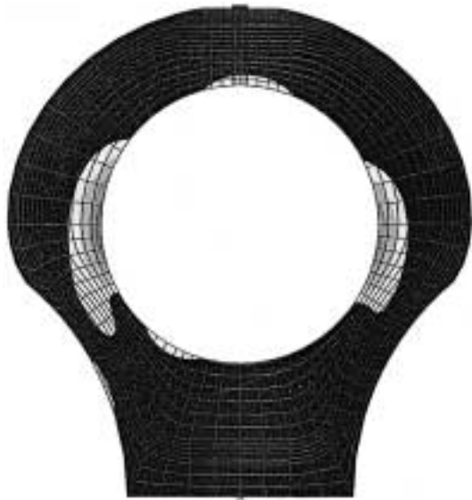
第2図 ロータのFEM解析 (600rpm, ΔP = 110kPa) Fig. 2 FEM analysis of rotor lobe
