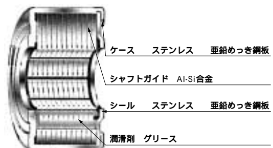
第1図 スベリベアリングの構造
