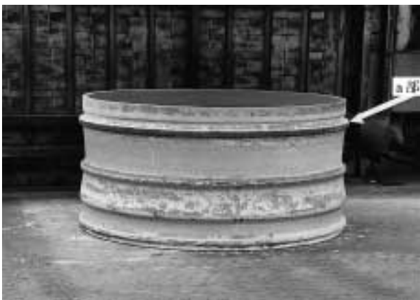
写真2 フロントのリング圧延形状の外観 Photo 2 Appearance of Ti-6Al-4V front ring
