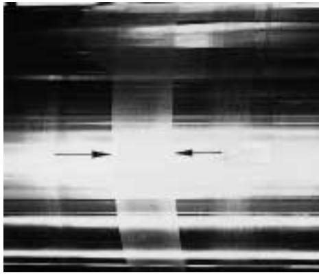
写真1 純チタン圧延後のロール表面状態 Photo 1 Roll surface appearance after cold rolling C. P. titanium
