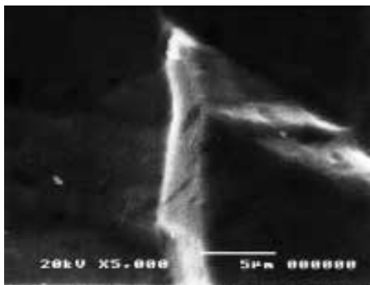
写真1 陽極酸化処理後の純チタン SEM 像 Photo 1 SEM image of anodized surface in C. P. T.
