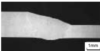
写真1 溶接継手部断面
