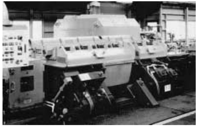
写真2 新サイジングミル Photo 2 New sizing mill
