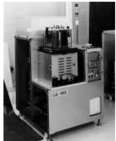
写真 1 SMIF 対応シリコンウェーハ一括移載機
