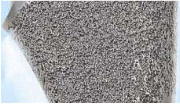
写真2 チタン粉末をプラズマ溶射することによって作成したポーラス表面
