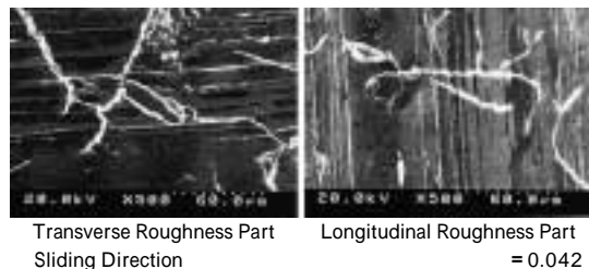
写真1 摩耗痕の塑性流動形態
