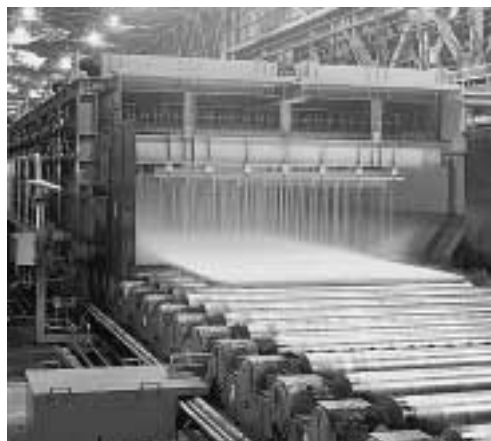
写真1 オンライン水冷設備の概観 9) Photo 1 Outlook of online accelerated cooling equipment
