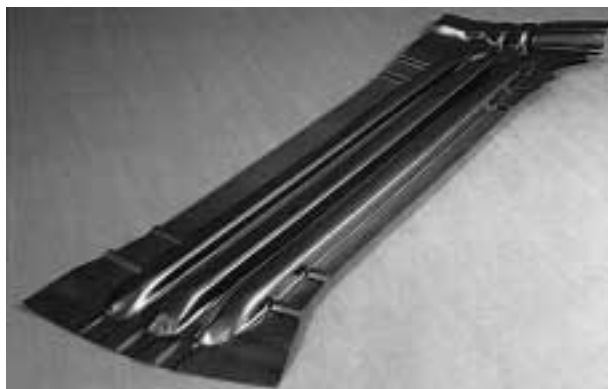
写真2 ドアガードバー成形品 Photo 2 Application to door guard bar
