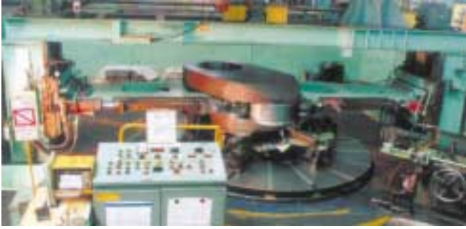
写真5 冷間ロール加工装置 (C型フレーム構造:新タイプ) Photo 5 Fillet cold rolling equipment (new type)
