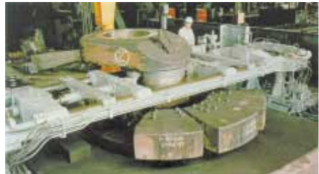
写真4 冷間ロール加工装置（井桁フレーム構造：旧タイプ） Photo 4 Fillet cold rolling equipment (previous type)
