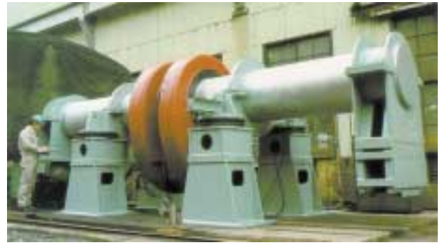
写真6 実体疲労試験装置 Photo 6 Fatigue testing machine for an actual-sized crankthrow
