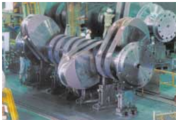
写真3 半組立型クランク軸 (MAN B&W タイプ 5S60MC-C) Photo 3 Semi built-up crankshaft (MAN B&W type 5S60MC-C)
