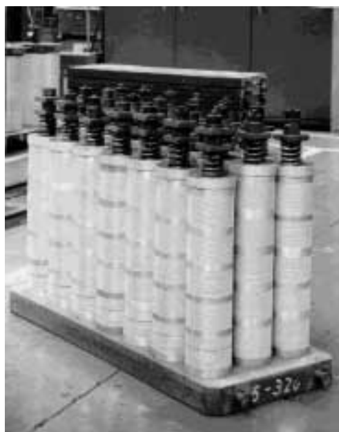
写真2 歪み矯正焼きなまし時のディスク Photo 2 Stacked disks for stress-relief annealing to be flated
