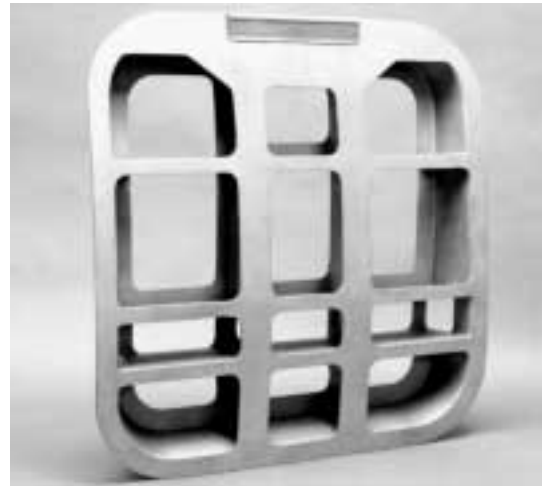
写真3 A357 合金製航空機用一体化構造ドア鋳物 Photo 3 Integrated structure door casting of A357 alloy
