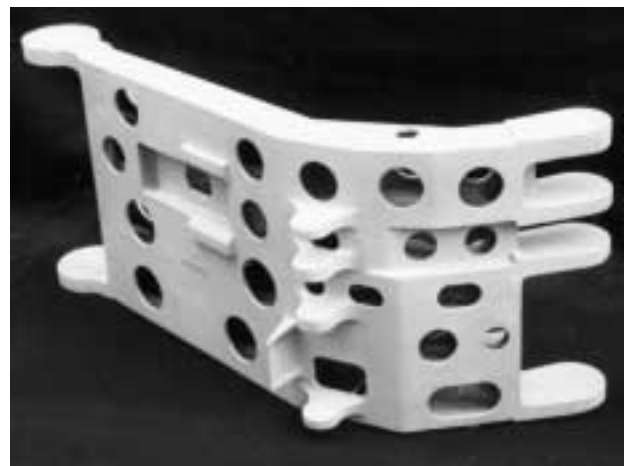
写真4 A357合金製航空機用ドアヒンジ鋳物
