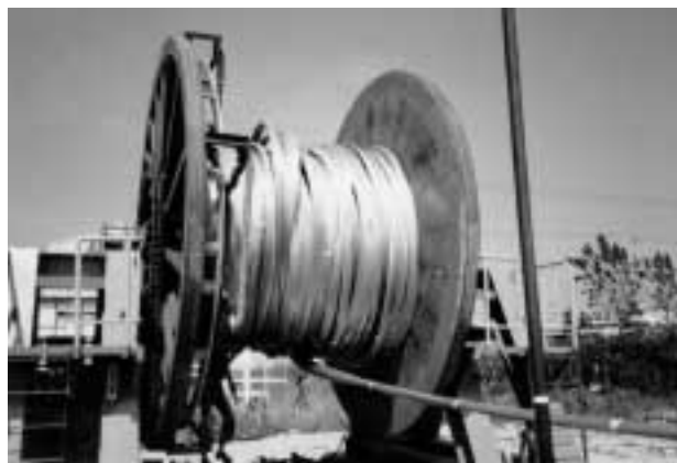
写真3 失敗した4000m-PWSの引出し実験 Photo 3 Failed unreeling experiment of 4000m-PWS
