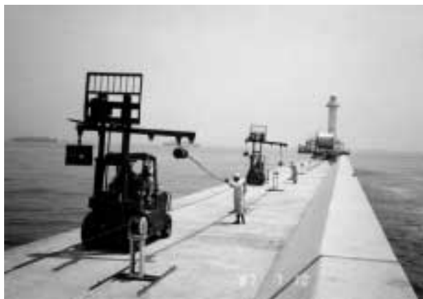
写真4 成功した4000m-PWSの引出し実験 Photo 4 Succeeded unreeling experiment of 4000m-PWS
