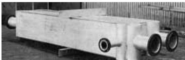
写真6 ALEX リバーシング熱交換器 Photo 6 Reversing heat exchanger "ALEX"
