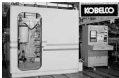
写真3 防護壁自装標準小型HIP装置 Photo 3 Standard compact HIP unit
