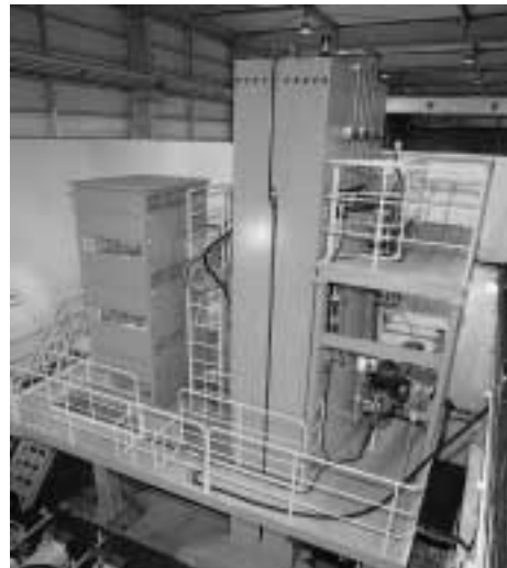
写真5 大型HIP装置 Photo 5 Large scale HIP unit
