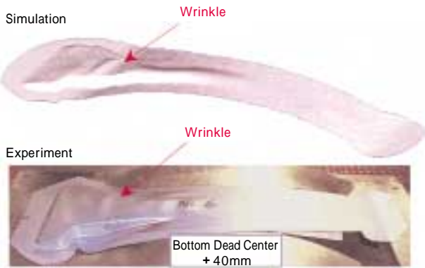
第2図 センタピラーモデルの成形シミュレーション Fig. 2 Forming simulation of B-pillar model
