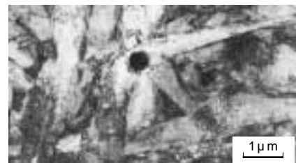
写真2 SMAW 溶接金属の電子顕微鏡ミクロ組織 Photo 2 TEM micrograph of SMAW metal
