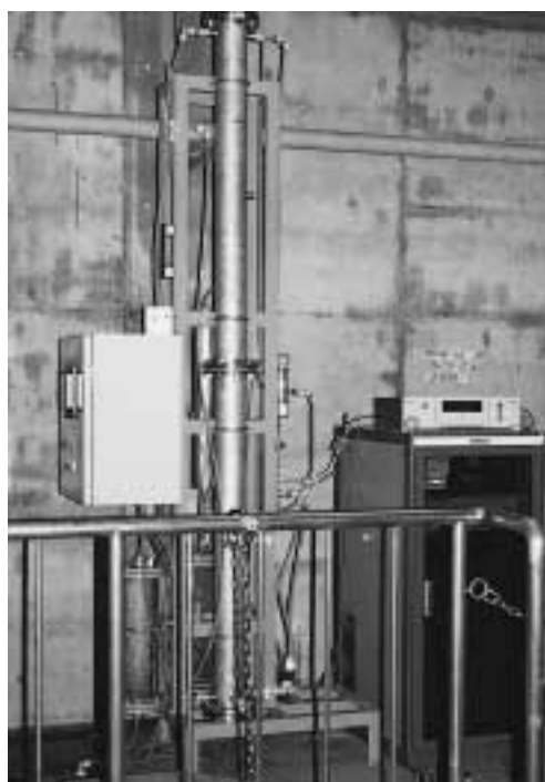
写真1 オゾン処理, UV 実験装置 Photo 1 Ozonation and UV treatment experimental plant
