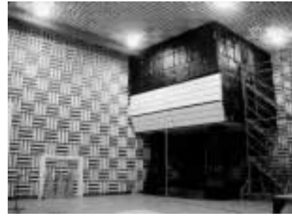
写真6 構造物音の遮音性能実験のために大型無響室に設置された実物大部分高架道路 Photo 6 Full-sized partial elevated road in our large anechoic room to evaluate performance of cover for structure borne noise
