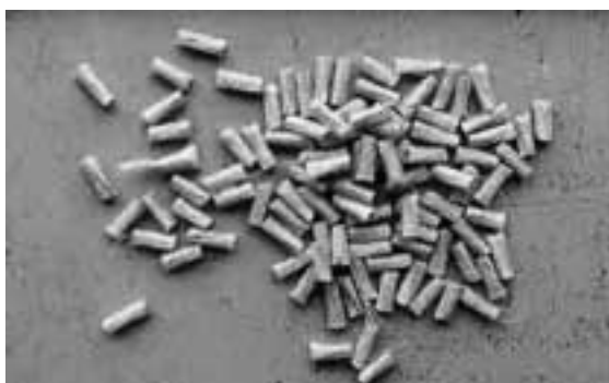
写真2 ジュートとPPの組合せによるペレット(エココンポジット)のサンプル Photo 2 Jute fiber reinforced PP composites pellets (E-LFP)
