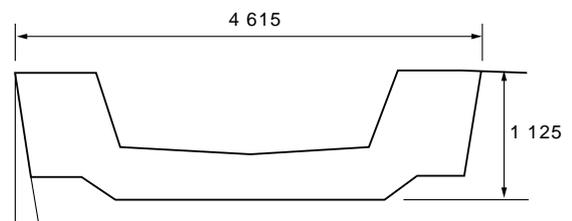
図5 部分型入前の素材形状
